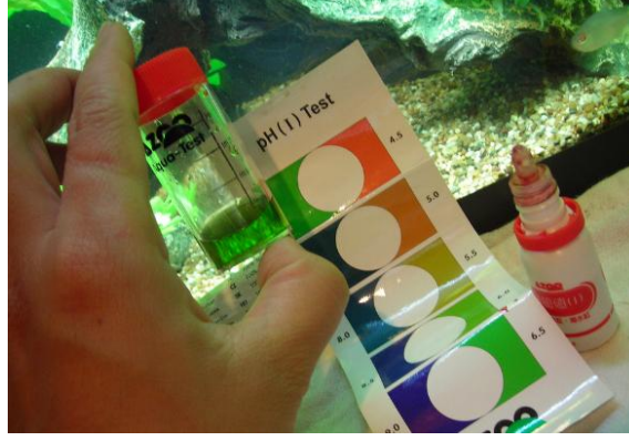
Resim 1.9: pH, renk değışkenlikleri ile pratik olarak ölçülmesi
