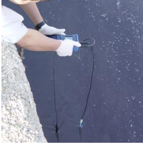
Resim 2.3: Askıdaki katı maddelerin ölçülmesi
