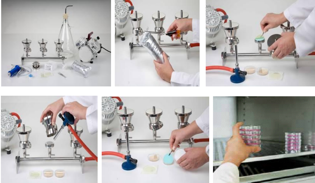
Resim 3.5: Membran filtre yönteminin uygulanması
